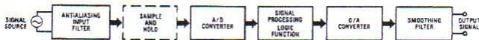
Figure 7 – Schema bloc generală a unui sistem de eșantionare a datelor (SDS) cu un singur canal.
